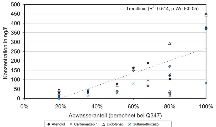
**Abb. 2** Konzentrationen der Arzneimittel Atenolol, Carbamazepin, Diclofenac und Sulfamethoxazol aufgetragen nach berechnetem Abwasseranteil bei Minimalabfluss (Q<sub>347</sub>) (s. Kap. 1.3 b). Messungen aus den Micropoll Messkampagnen 2007 [12] und 2009/10.
