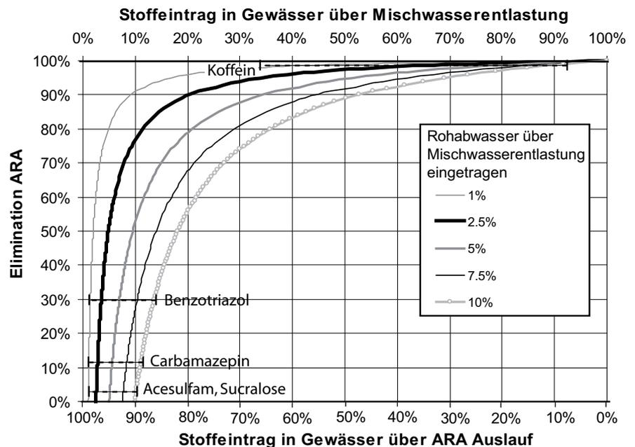
**Abb. 3** Berechneter Anteil des Eintrages über Mischwasserentlastungen in Mischsystemen, abhängig von der Elimination in ARA. Ein Anteil von 2,5% des Rohabwassers über die Entlastung der Mischwasserkanalisation in Gewässer, entspricht einem durchschnittlichen Wert im Schweizer Mittelland.
