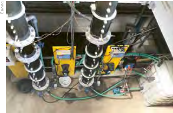
Essais pilotes de filtration sur CAG à la STEP de Muri
