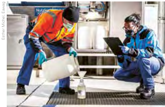
Une partie d'un échantillon composite d'eau usée est prélevée à la station d'épuration pour être analysée au laboratoire.
